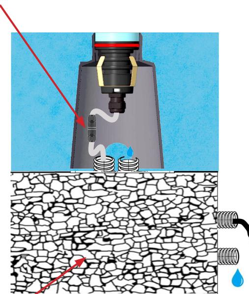
Il fondo della cassaforma deve essere a contatto con materiale drenante per non permettere ristagno d'acqua per lunghi periodi e agevolarne lo scarico tramite condotti.
