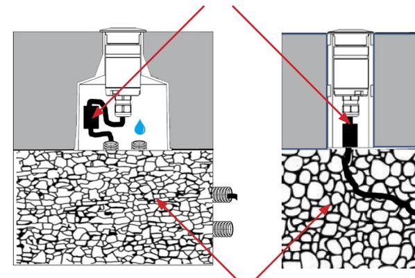
Il fondo della cassaforma deve essere a contatto con materiale drenante per non permettere ristagno d'acqua per lunghi periodi e agevolarne lo scarico tramite condotti.
